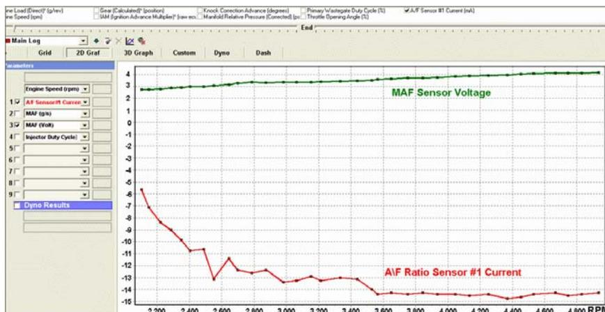
С помощью такого ПО для перепрограммирования и программ записи и анализа параметров (логгеров) и используя «родные» протоколы обмена данными (e.g. ssm, mut-II, etc.) можно получить доступ к данным, которые не доступны обычным (generic) сканерам, как впрочем и значительно большие скорости обмена. И, например, анализировать 3D-графики (рис.
