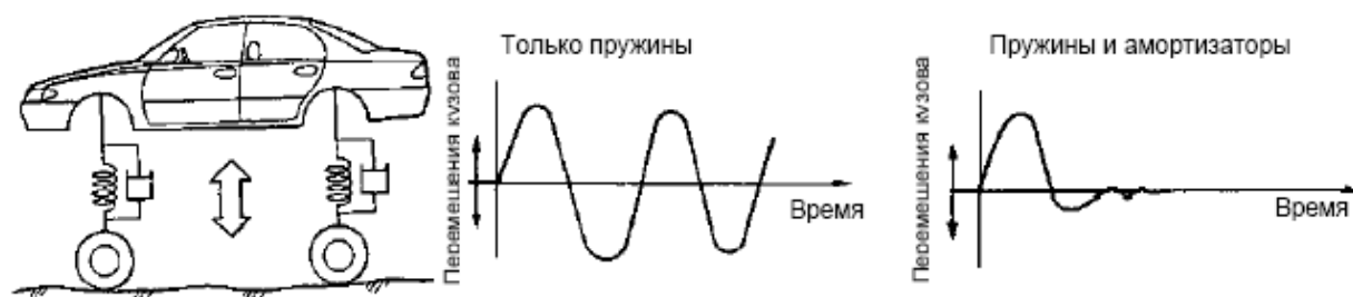
Рис. 2.36. Колебания кузова, вызванные ударами при наезде на неровности дороги
