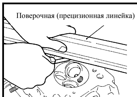
Рис. 4-36 Проверка неплоскостности блока цилиндров
