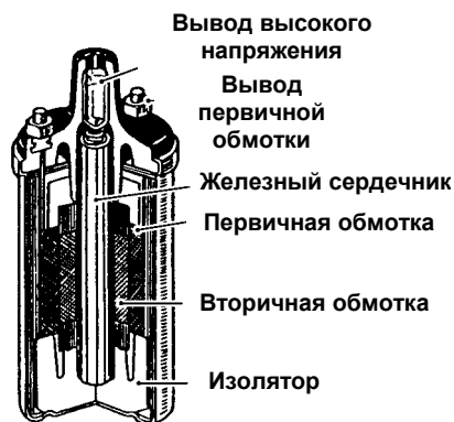
Катушка зажигания Рис 27-21
