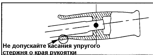
Рис. 4-25 Неправильный способ работы динамометрическим ключом
