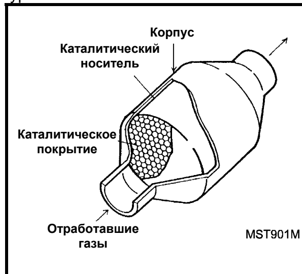
Рис. 8-40 Каталитический нейтрализатор ОГ
