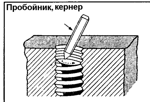
Рис. 5-12 Удаление сломанного болта
