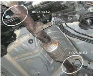
Оговорю, что в «исходном состоянии» автомобиль полностью исправен и напомним, что в нем используются широкополосный датчик второго поколения «планарного типа» и еще два последовательно установленных кислородных датчика B1S2 и B1S3.
