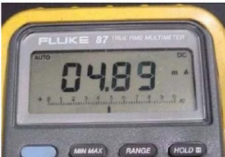
Ток датчика при обедненной смеси
